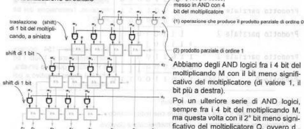
Ad ogni traslazione (shift) di 1 bit a sinistra, si moltiplica il moltiplicando per i bit di peso crescente del moltiplicatore fino ad ottenere i bit di peso più basso fino a quelli di peso più alto, da destra verso sinistra. Da due fattori di 4 bit si ha un prodotto di 8 bit. da  $p_7$  a  $p_0$ .
