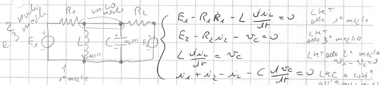
Quando le LK vengono eliminate, per sostituzione, gli unici
