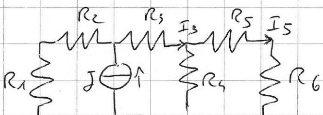
Dato il circuito, si inizia a semplificare:  $R_5$  e  $R_6$  in serie;  $R_4$  e  $R_5$  sono in parallelo.
