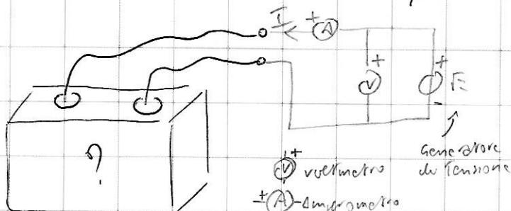
Per capire il circuito di un resistore solo i mettiamo, creando delle tensioni attraverso il generatore di tensione e misurando le correnti nel circuito.
