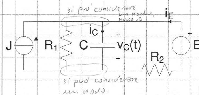
$$\begin{aligned} \text{LKC} \quad & \frac{v_C}{R_1} + i_C - i_E = J \\ \text{LKT al nodo A} \quad & R_2 i_E + v_C = E \\ \text{perche' l'interruttore e' chiuso.} \quad & i_C = C \frac{dv_C}{dt} \end{aligned}$$
