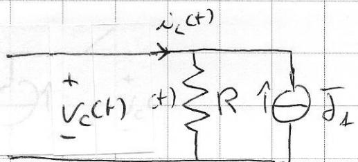
Per  $t < 0$  l'interruttore è aperto, il condensatore si comporta come un circuito aperto, l'induttore si comporta come un cortocircuito.
