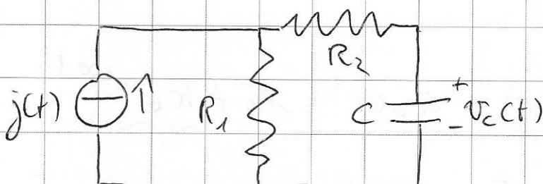
$$R_2 i_2 - R_2 C \frac{dV_c}{dt} - V_c = 0 \quad (K.T. \text{ modello di de})$$
