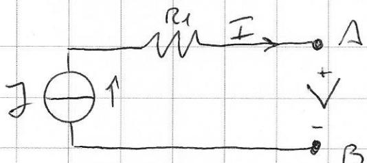
in cui il circuito equivalente di Thévenin non esiste, perché avremmo una resistenza equivalente infinita e una tensione a vuoto infinita già ovvero una corrente di valore finito.
