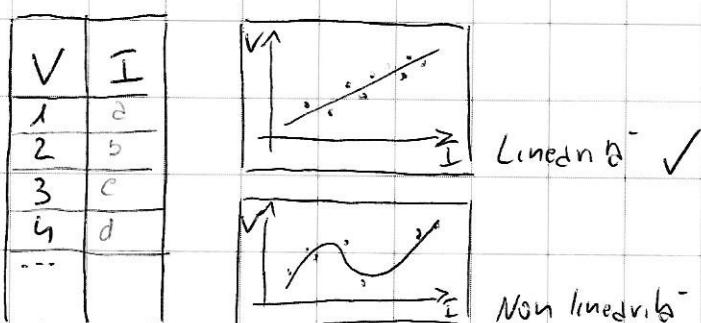
Faccendo diverse misurazioni otterremo una retta della corrente in funzione delle tensioni create.
