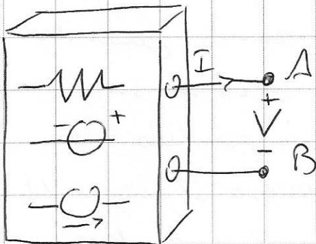
Inizialmente su morsetta A-B, si pone riguardo il circuito che voglio schematizzare con Thévenin o con Norton sto facendo la convenzione del generatore perché lo corrente I del lato del circuito da schematizzare va dal nodo A al nodo B.
