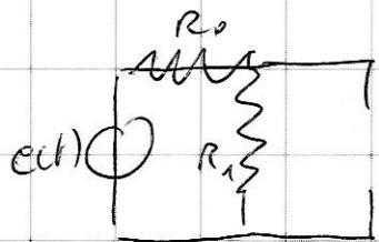
Con un parallelo di tensione si calcola  $e_o(t)$  perché la tensione su capo del condensatore quando siamo a vuoto è uguale alla tensione su capo di  $R_1$ . In un esempio
