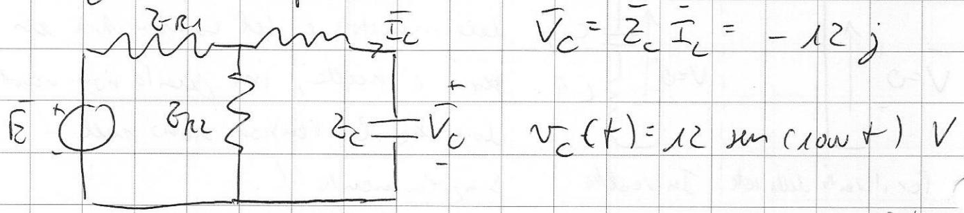
Altenzione alle frequenze: non basta che un condensatore e un induttore siano in parallelo per avere che c'è risposta.
