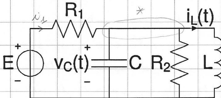
$$\begin{cases} E - R_1 i_1 - v_C = 0 & \text{LKT 1^a media} \\ v_C = R_2 i_2 = L \frac{di_L}{dt} & \\ i_1 - C \frac{dv_C}{dt} - i_2 - i_L = 0 & \text{perche' in parallelo} \end{cases}$$
