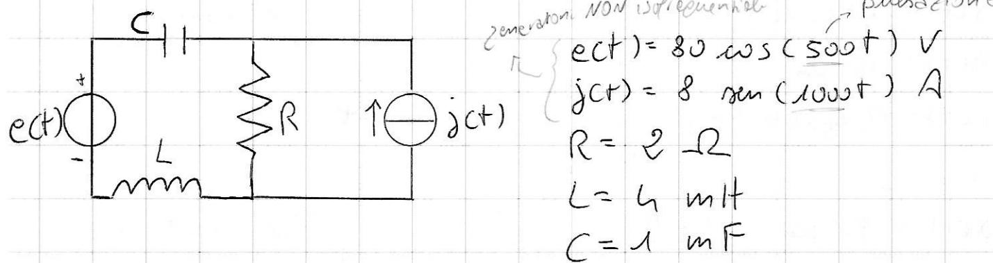
DEVE ESSERE VATO IL PRINCIPIO DI SOPRAPOSSIZIONE DEGLI EFFETTI PERCHE' NON E' POSSIBILE INTRODURRE I FASORI IN UN CIRCUITO CON UN GENERATORE NON ISOFREQUENZIALE, MA I FASORI ACTUALI NON SAPRANNO SE IL FAISCE E' DIFFERENTE A UNA PULSAZIONE 1000 O A UNA PULSAZIONE 500. QUINDI, DI PER SE' I FASORI NON SI POSSONO INTRODURRE.
